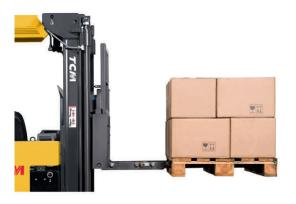
Для моделей SRO и SSO предусмотрена возможность дополнения телескопическими вилами, как модели SRT и SST. Эти погрузчики позволяют работать с поддонами двойной глубины, чтобы сократить ширину прохода еще больше, или загружать и разгружать транспорт с одной стороны. В некоторых случаях эта функция может заменить небольшой ричтрак.
